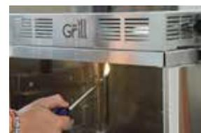
Откройте вентиль вдавливая и вращая его против часовой стрелки, одновременно поднесите огонь зажигалки под газовые горелки. Открытие вентиля и поджигание горелок должны осуществляться одновременно! Если вначале открыть вентиль и спустя несколько секунд поднести огонь зажигалки под газовые горелки возникнет объемное воспламенение газа внутри гриля, что может привести к испугу и ожогу. После возгорания газовых горелок держите вентиль в вдавленном/нажатом положении в течение 20 секунд.
