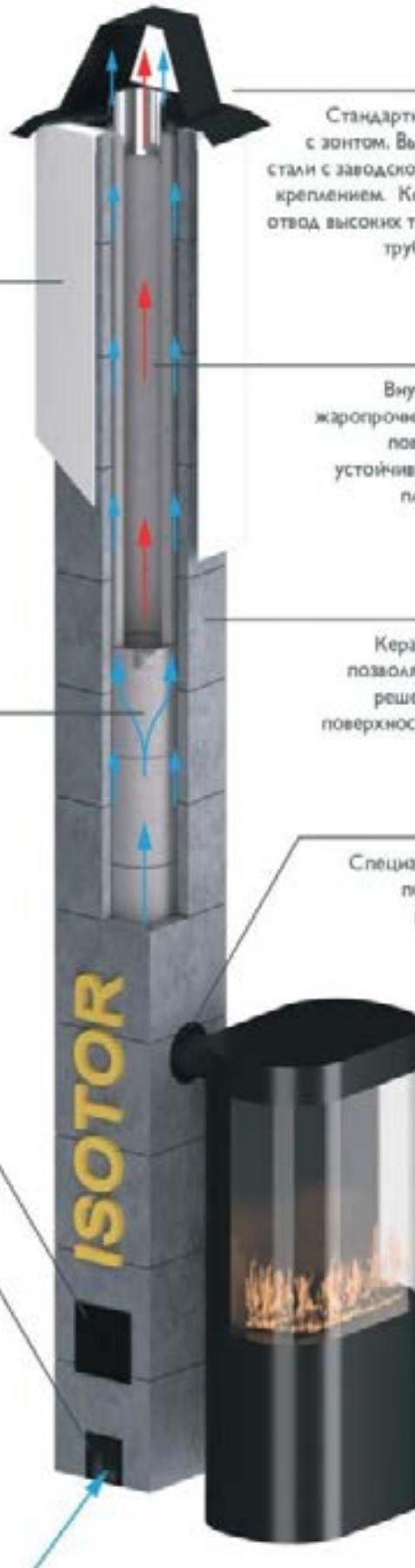
Стандартный фирменный оголовок с зонтом. Выполнен из нержавеющей стали с заводской покраской и надежным креплением. Конструкция обеспечивает отвод высоких температур от внутренней трубы дымоходной системы.
