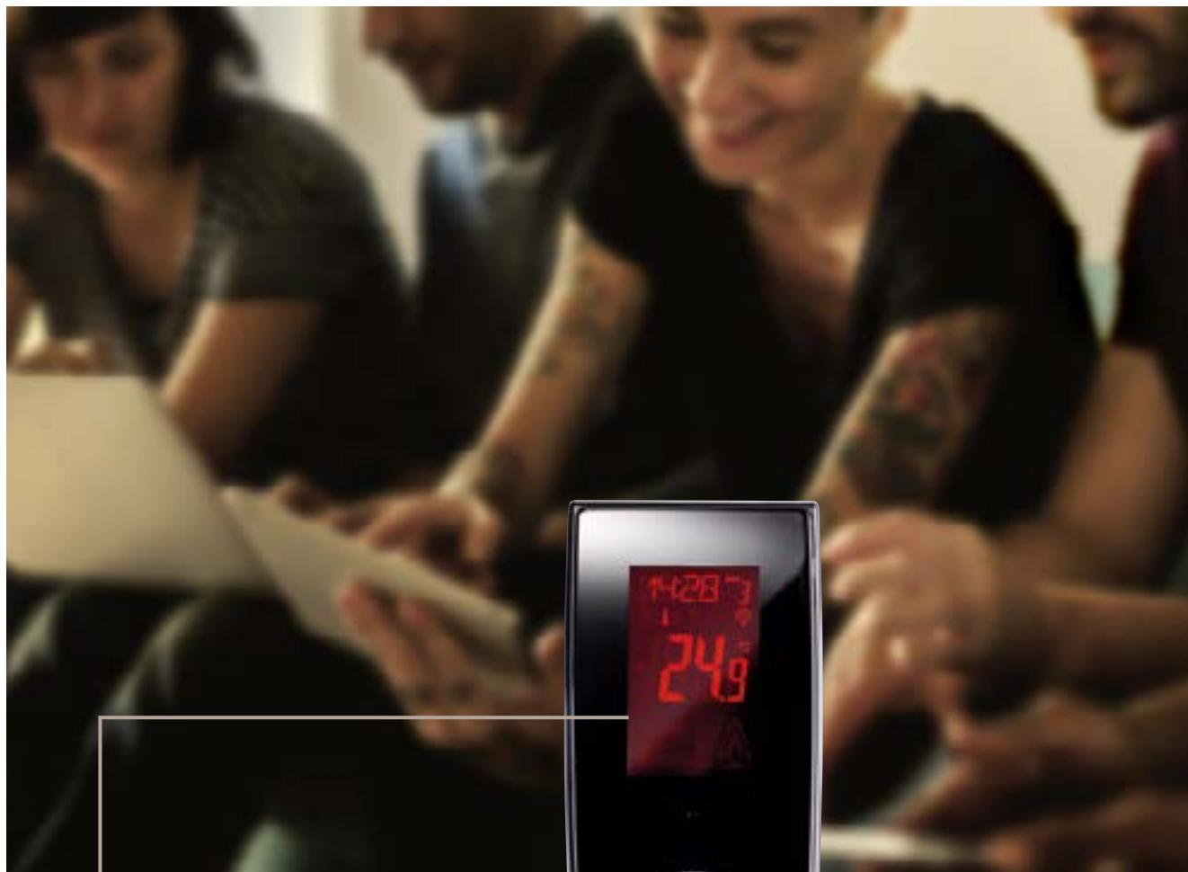
Дисплей информирует о работе камина, выбранном рабочем режиме, неисправностях, температуре в помещении, состоянии батареи, высоте пламени, энергосберегающем режиме. С помощью пульта дистанционного управления можно запрограммировать работу камина в автоматическом режиме.
