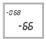
Здесь показаны значения RSSI (Индикатора силы сигнала ресивера). В верхнем левом углу RSSI пульта ДУ и в нижнем правом углу RSSI газового трансивера декоративного камина (DFGT).
